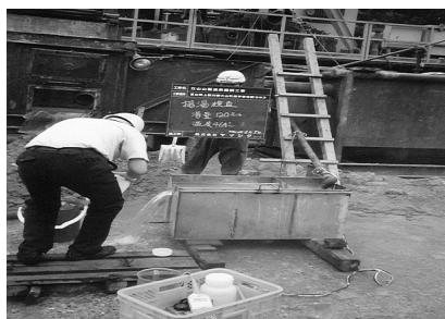
揚湯試験 湯量120ℓ・温度46.4℃
